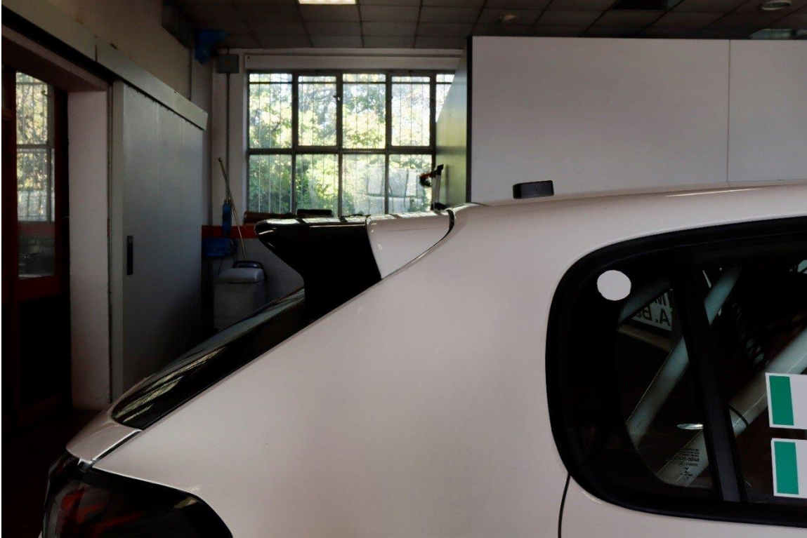
Fig. 6: antenna a tetto installata sul veicolo
